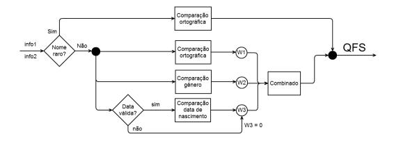
Figura 1. Diagrama de blocos do cálculo da medida QFS
