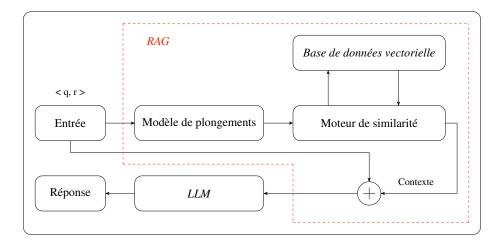
FIGURE 2 – Architecture générale des approches génératives enrichie par le mécanisme de RAG
