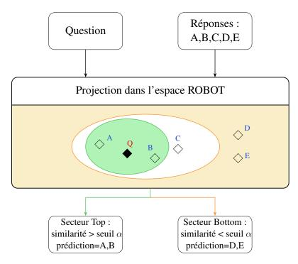
FIGURE 1 – Architecture du système ROBOT avec seuil  $\alpha$ . Le secteur Top est en vert et le secteur Bottom est en jaune.
