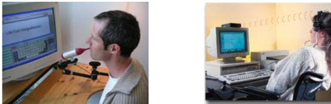
**Figure 2.** Deux exemples de dispositifs d'entrée : à gauche, une commande par détection de souffle ; à droite, un détecteur de mouvements de tête
