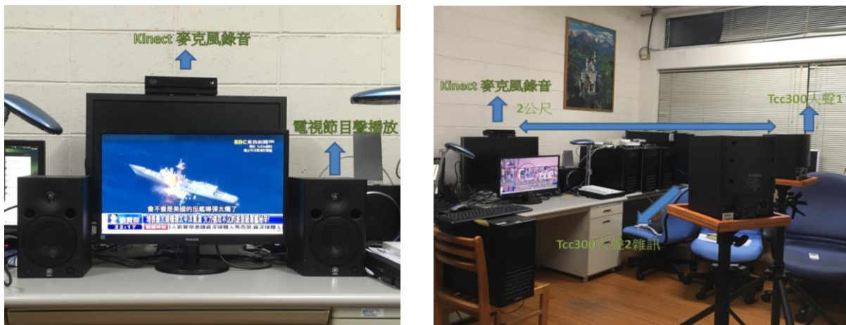
圖 9 實際電視喇叭、收音麥克風與實際模擬說話者之音源喇叭擺設
