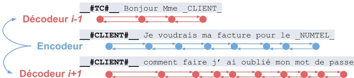
FIGURE 1 – Schéma du modèle *Skip-Thought* utilisé. Le modèle encodeur produit une représentation du  $i$ -ème message (concaténation des états cachés finaux des deux directions du modèle récurrent) qui est ensuite utilisée pour conditionner deux décodeurs récurrents respectivement sur les  $(i - 1)$  et  $(i + 1)$ -èmes messages, en espérant ainsi forcer cette représentation à capturer des informations sémantiques conversationnelles.
